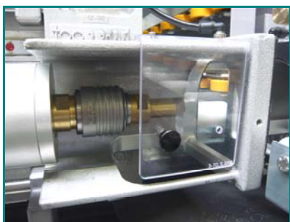
Druckplatte mit Spritzwasserschutz
