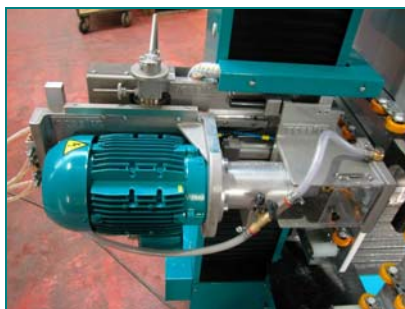
Bohrkopf aus Alu mit Sensoren
