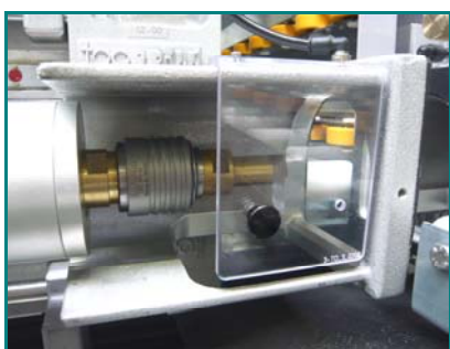
Druckplatte mit Spritzwasserschutz
