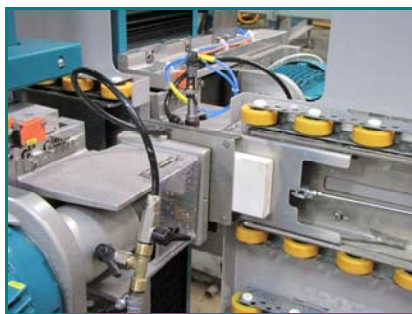
Schärfereinheit ausgefahren in Aktion
