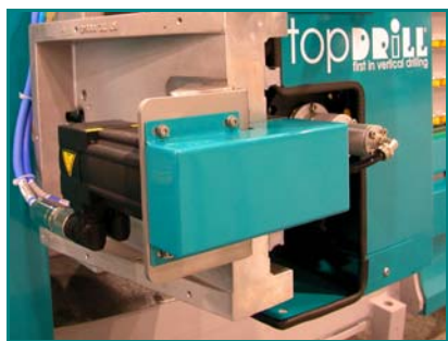
Digitale Z-Achse mit Servomotor
