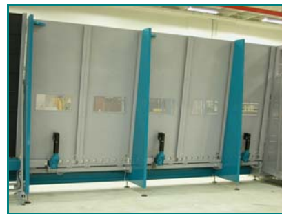
pro Modul ein Servomotor
